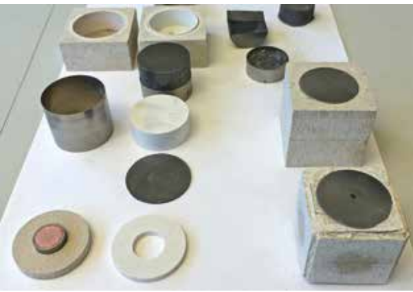
Kubische Reaktionszellen bei Swiss Diamond Vision.
