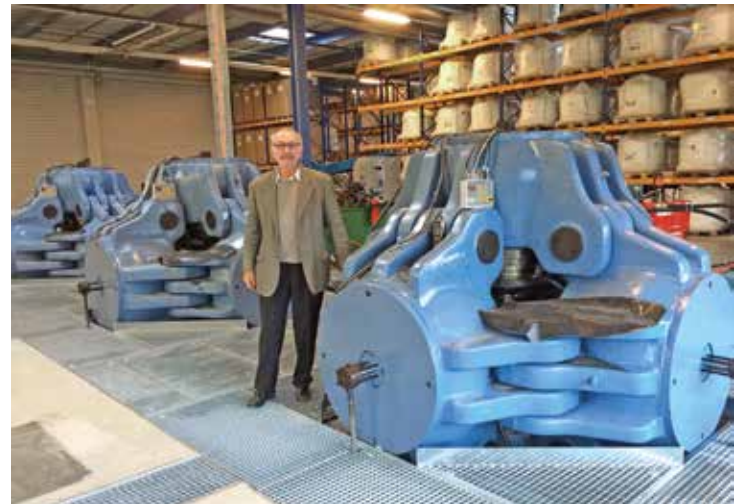
Drei HPHT-Diamantpressen bei der Reishauer AG in Pfaffnau.
